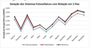
Figura 11 - Geração de energia dos FV 1 eixo.
