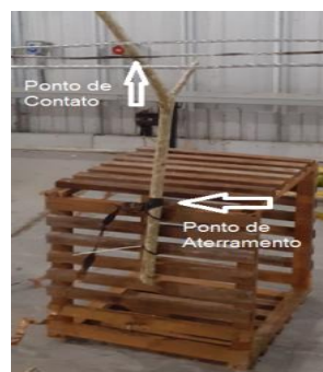
Figura 5. Galho de Ipê Roxo próximo ao cabo e aterramento distante a 0,5 metros.
