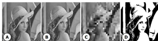
Fig. 3 Influência da variação dos parâmetros N , M e G na qualidade uma imagem monocromática. (a) 200 x 200 pixels/256 níveis (b) 100 x 100 pixels/ 256 níveis. (c) 25 x 25 pixels/ 256 níveis. (d) 200 x 200 pixels / 2 níveis
