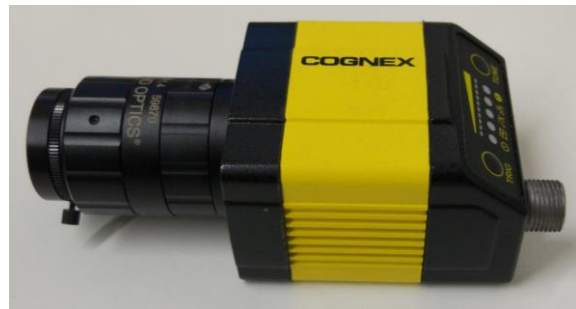
Figura 3. Cognex DM303x com lente 16mm/F1.4 acoplada.
