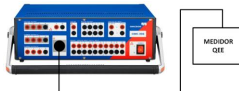
Fig. 1. Esquemático da conexão entre a mala de teste OMICRON e os medidores de QEE.
