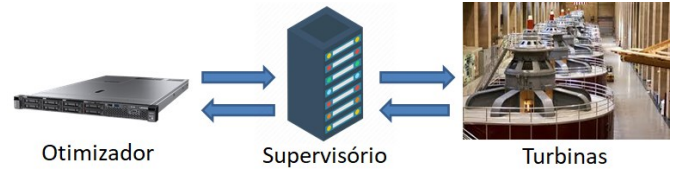
Fig. 2: Integração do otimizador com o supervisor e este com as turbinas.
