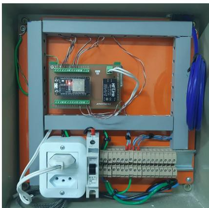
Fig. 12 Painel de controle do segundo sistema.
