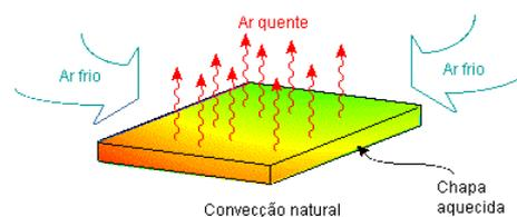
Fig. 3 Transferência de calor por convecção natural. (Solidworks, 2019)
