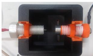
(b) Foto da célula com a configuração ponta-plano.
