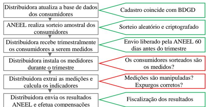
Fig. 1 Etapas da medição amostral. Adaptado de Neto (2018).
