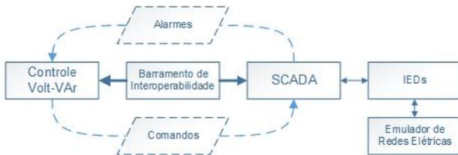
Fig. 7 Arquitetura da interação entre os módulos.
