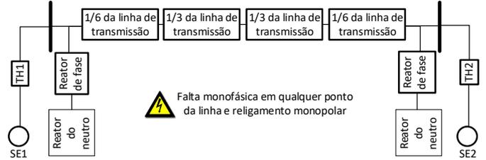
Figura 4. Sistema teste com transposição real.
