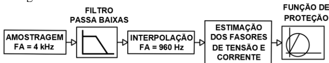
Fig. 7. Etapas do processamento de dados do relé de distância implementado.
