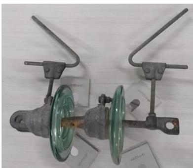
Fig. 3 Descarregador de chifre.
