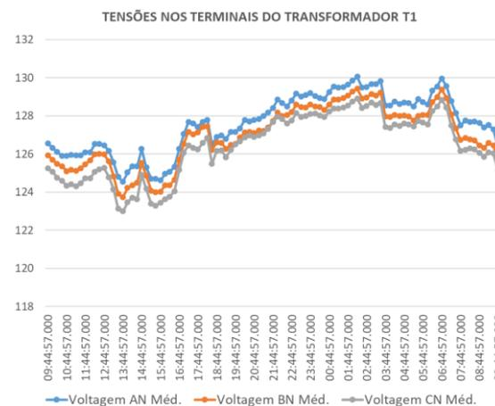
Fig.20 Tensões de fase nos terminais de T1
