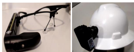
Fig. 5. Smart Glass e SBCAM acoplada no capacete.
