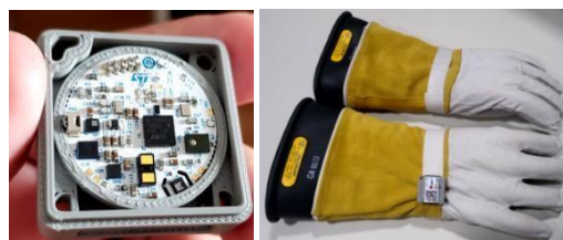
Fig. 3 Sensor SNODE: protótipo e aplicação em luva.
