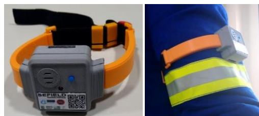
Fig. 4. Sensor SEFIELD: protótipo e aplicação no braço.
