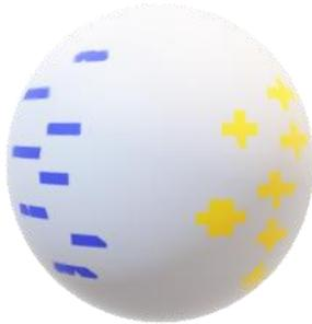
Fig 1. Representação da migração de cargas positivas e negativas quando submetidas a campo elétrico externo em uma cavidade interna a um material isolante.
