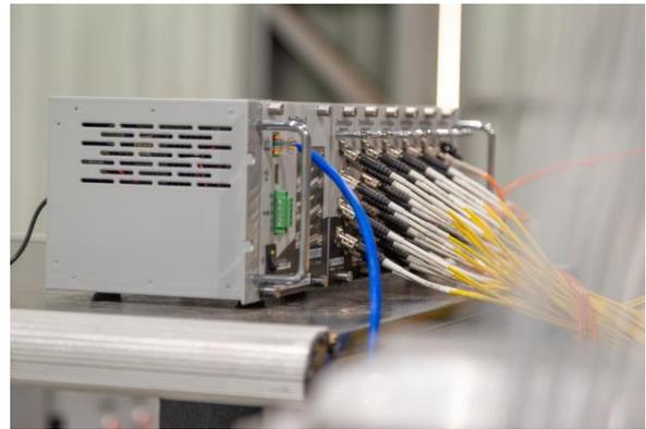
Fig. 4 Equipamento Qualitrol® Omniflex.
