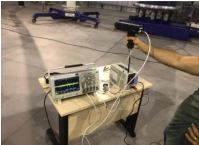
Fig.6: Medição de DP utilizando pistola e osciloscópio.
