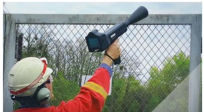
Fig. 5: Pistola de ultrassom Ultraprobe 15000 da UE System
