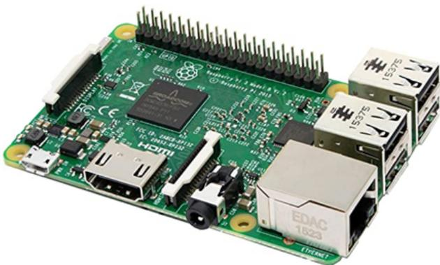
Figura 4. Raspberry Pi 3. Adaptado de (Upton, 2017).
